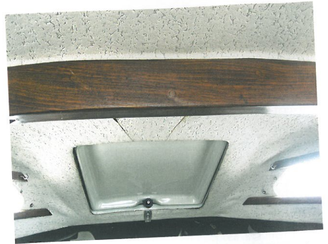
Ein solider Decksbalken nimmt den Mastdruck auf, das einlaminierete Hauptschott leitet die Kräfte in den Rumpf. Das Vorluk besteht auf jüngeren Exemplaren aus Plexiglas.
