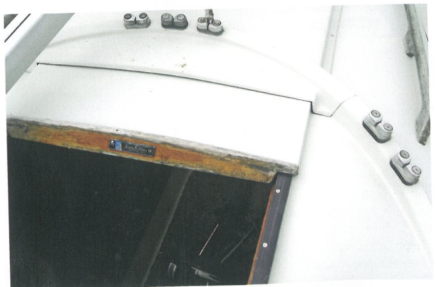
Alle Trimmleinen sind auf ein eingeformtes Süll vor dem Niedergang geführt und ausreichend untersetzt, um sie ohne Winschen zu bedienen. Letztere wurden auch nie als Standard montiert.
